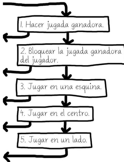
Figura 10-4: Los cinco pasos del algoritmo “Obtener movimiento de la computadora”. Las flechas salientes van al recuadro “Comprobar si la computadora ha ganado”.
